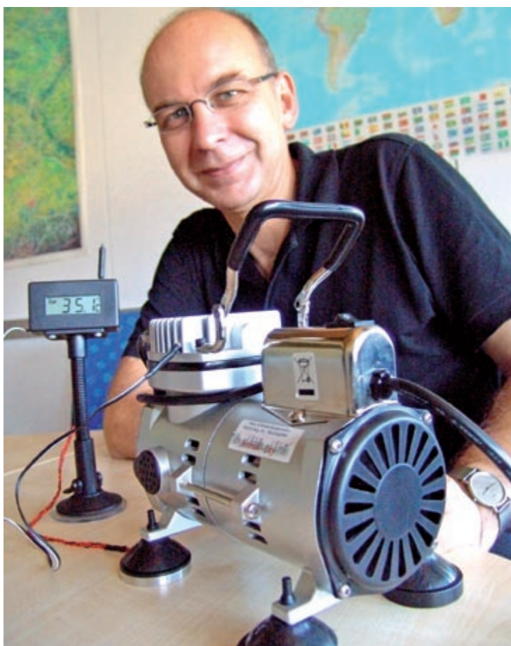
Das Thermometer bezieht seine Energie ausschließlich aus den Vibrationen des Kompressors. Prof. Peter Woias möchte solche Mikroenergie konsequenter „ernten“.
