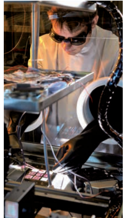
Arbeit in der Glovebox, einem luftdichten Glaskasten, der die Solarzellen (rosa Quadrate) vor Umwelteinflüssen schützt.
